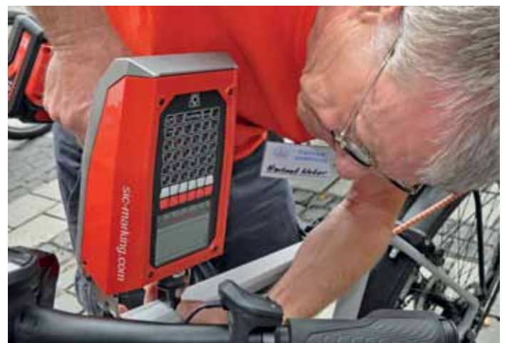
Ein Nadelmarkierer überträgt den Code auf den Fahrradrahmen.
