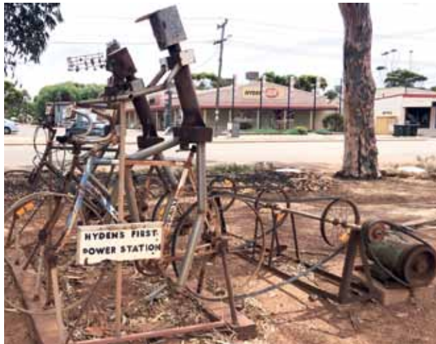
Radpionier in Australien. Mick Mouritz hatte sich 1924 in Australien aufs Fahrrad gesetzt und einen guten Platz für eine neue Siedlung gesucht. Daraus wurde der Ort Heyden bei den Wave Rocks. Wie dort das erste kleine Kraftwerk aussah, mit Pedalkraft betrieben, ist heute noch zu sehen. Herbert Sitterle hat fotografiert.
